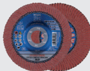
POLIFAN lepezasti brusevi A SGP CURVE ALU za brušenje sučeonih šavova (jedini lepezasti brus sa lamelama na onodu i specijalno razvijenom oblogom koja sprječava prijanjanje opiljaka)
